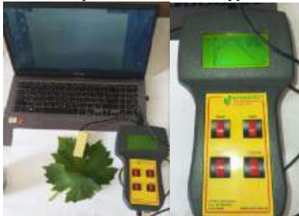
Рис 1. Портативный хронофлуорометр «Флоратест», разработанный институтом кибернетики им. В.М. Глушкова НАН Украины [8].
