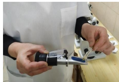
Фото 5. Нанесение образца на пластину прибора
