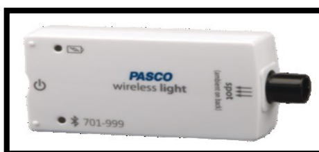
Figura 2. Senzorul wireless de lumină (PS-3213) [3]
