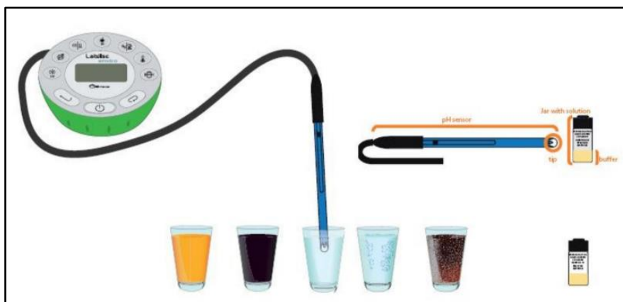
Fig. 1. Echipamente necesare pentru experiment: labdisc, senzor pH, pahare cu diverse soluții
