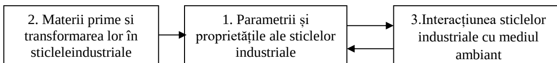
Fig.1. Schema bloc a factorilor, care influențează microduritatea sticlelor industriale
