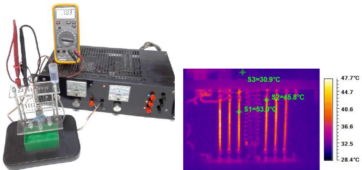
Figura 5. Stand experimental de picurător / dozator și imagine în infraroșu a arcurilor de Nitinol în timpul testărilor
