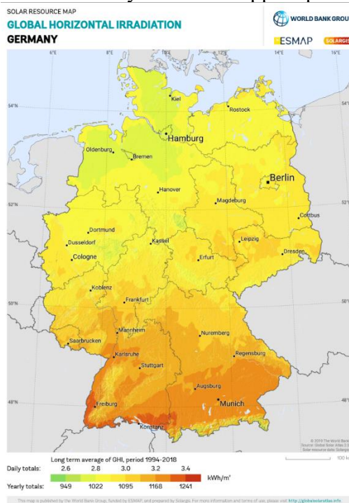
Рис. 3. Карта солнечного излучения на Территории Германии Источник: База данных, располагающая данными по уровню солнечного излучения https://solargis.com/
