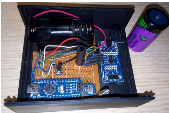
Figura 3. Senzorul de măsurare a gradului de umplere a containerului, interior – stânga, exterior - dreapta
