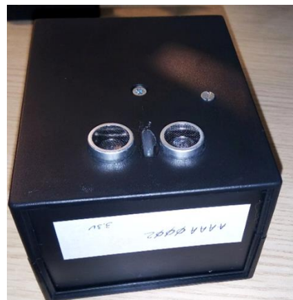
Figura 3. Senzorul de măsurare a gradului de umplere a containerului, interior – stânga, exterior - dreapta
