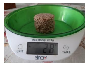
Figura 4. Cântărirea cilindrelor de pâine.
