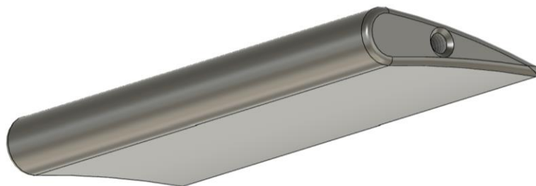
Figura 4. Paleta turbinei principale a motorului eolian cu două turbine (8 buc)
