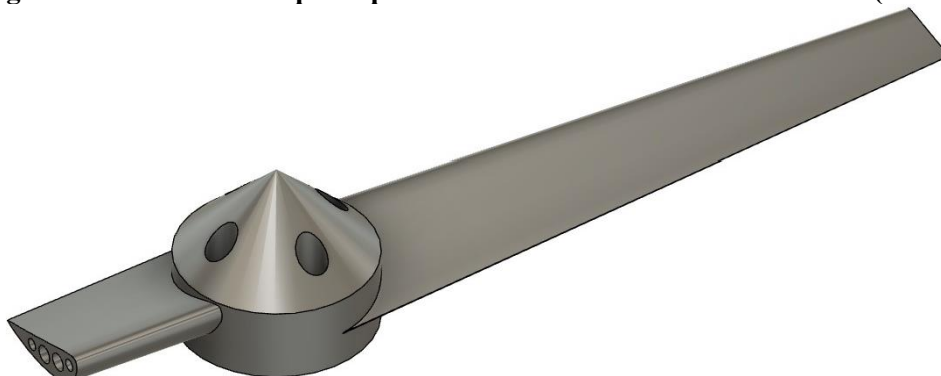
Figura 5. Turbina secundară a motorului eolian cu două turbine
