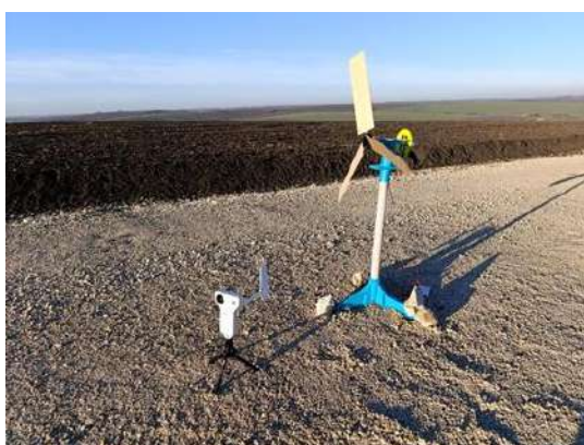
Fig. 4. Stație meteorologică fără fir cu GPS (PS-3209 / PS-3553)
