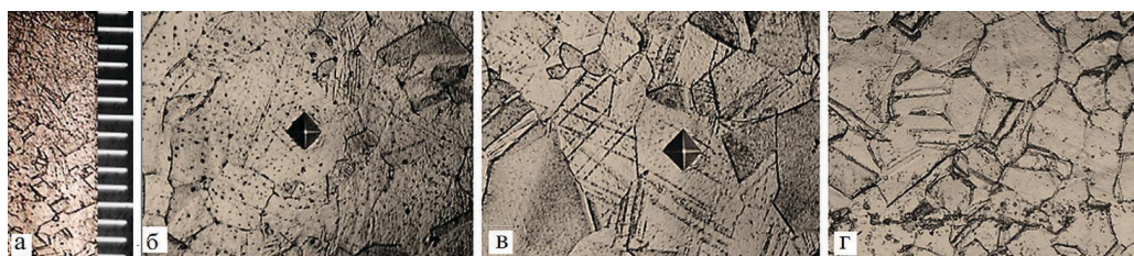
Рис. 1. Сталь AISI 316L, сухое трение «металл/металл»: AISI 316L/сталь СтЗсп, вид на плоскости в сечении, длительность трения t = 1 час; а– микроструктура образца при небольшом увеличении, сверху поверхность трения, 1 деление масштабной линейки равно 10 мкм; б-г – вид микроструктуры образца и отпечатков твердости, нанесенных на разных расстояниях от поверхности трения; горизонтальная сторона каждого кадра равна 180 мкм.
