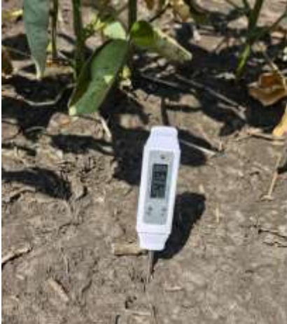
Foto 1. Monitorizarea temperaturii solului cu ajutorul senzorului wireless PS-3201 cu sondă din oțel inoxidabil
