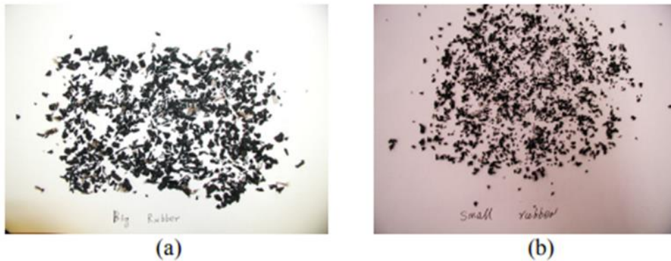
Figura 3: (a) Particule mari de cauciuc cu dimensiunea medie de 4,12 mm (b) Particule mici de cauciuc cu dimensiunea medie de 1,85 mm
