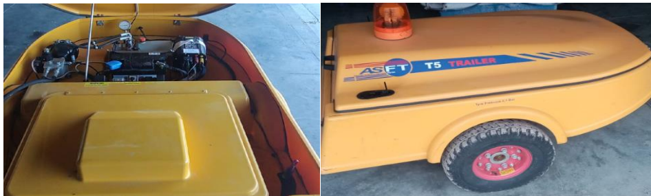
Figura 1. Echipament măsurare coeficient frecare- ASFT T5
