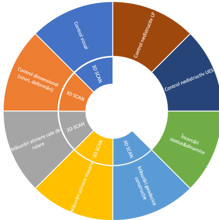
Fig. 1. Volumul examinării componentelor de macara
