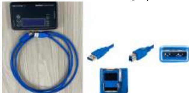
Fig.2. Tableau Forensic USB 3.0 Bridge și conectorii USB 3.0-A (9 pini), USB 3.0-B
